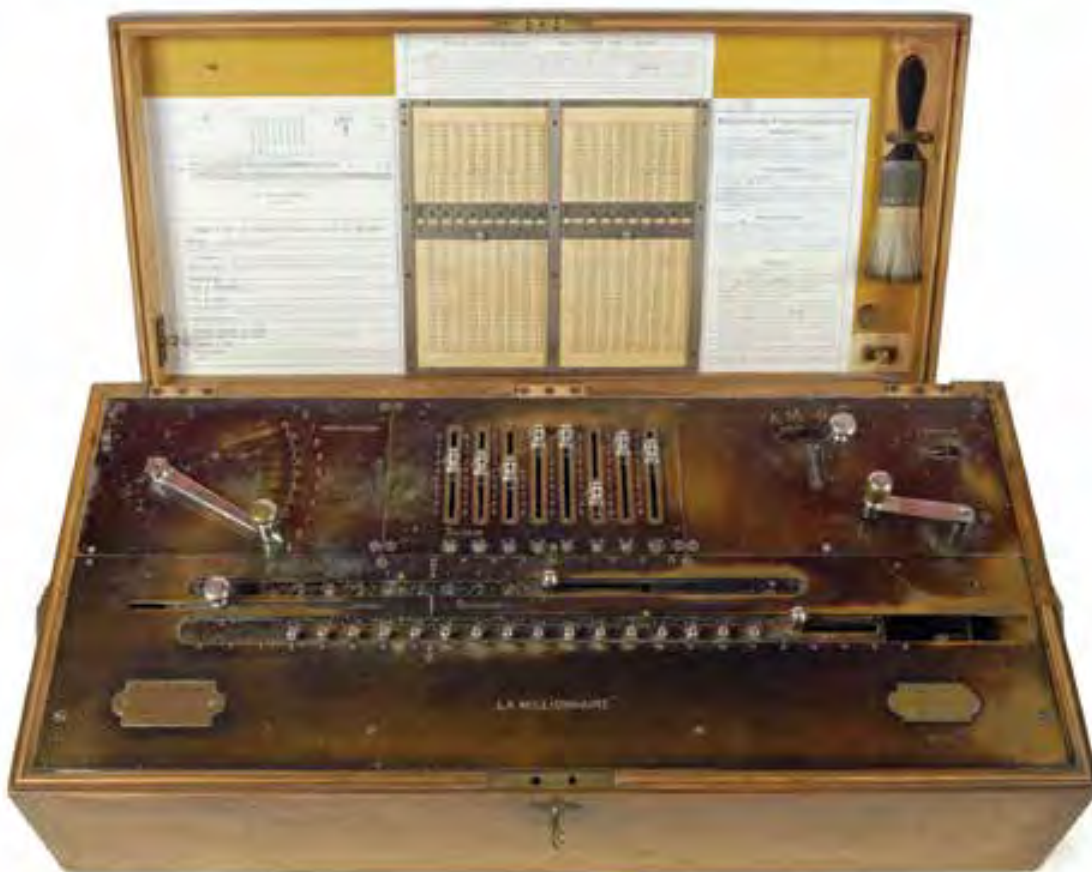
Arithmomètre, La Millionnaire, Acier/Cuivre/ Bois (boîtier), 14,5 x 27,7 x 36,8 cm. Collection du Planétarium de Bruxelles
