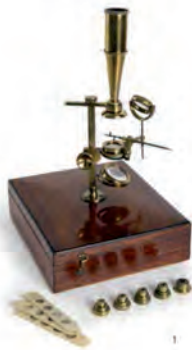
1. E. PALMER, Microscope , 1830-1850, Londres. Verre, laiton, bois et textile, 9 x 27,5 x 15 cm, N° inv. D243, UCL - Dépôt de la donation P. A. Roucoux. Petit objet de technologie pour l'époque, ce microscope s'adapte aux besoins de l'observateur sur le terrain ou en laboratoire. De microscope simple (l'oculaire et l'objectif ne font qu'un), il peut se monter en microscope composé, grâce aux cinq objectifs qui l'accompagnent.
